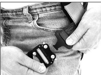
**Hebilla de conexión rápida:** Introduzca la lengüeta de la hebilla en el receptor de la hebilla de conexión rápida hasta oír un chasquido.
